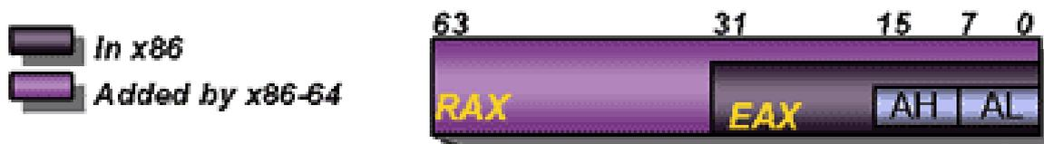
Figura 16: Estrutura de compatibilidade dos registradores
