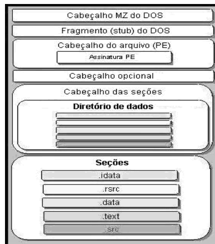
Figura. 2.1 Estrutura do formato Portable Executable (DUMMER, 2006)
