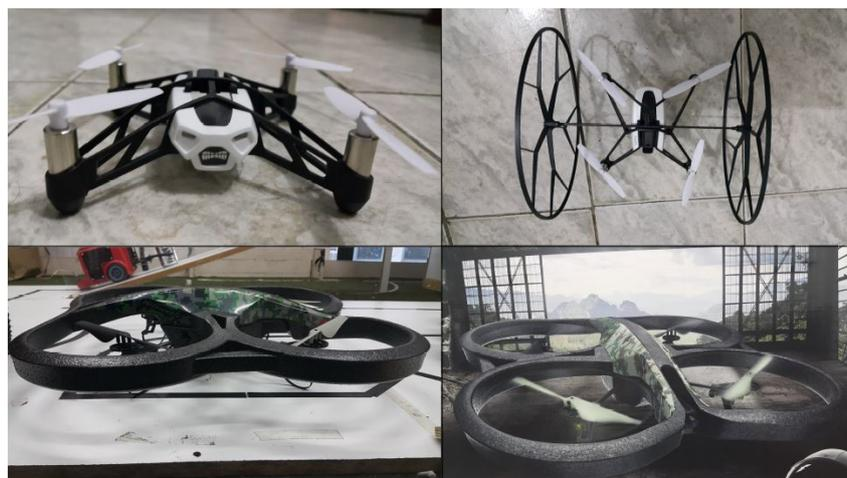
FIG. 2.3: Exemplo de VANTs de asas rotativas
