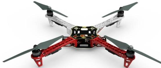
FIG. 3.5: ARF DJI F450 montado (DJI, 2017).
