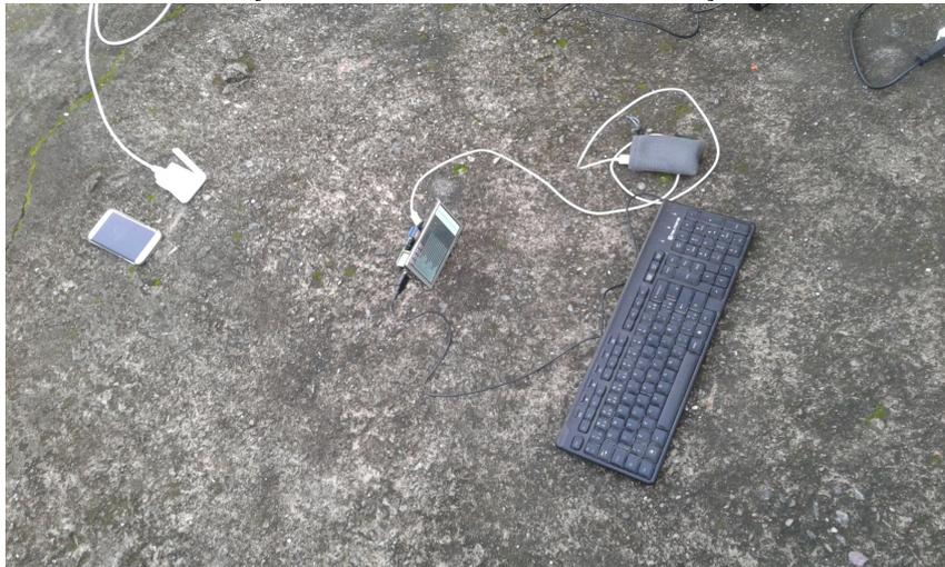
FIG. 3.8: Medição da potência do sinal com os equipamentos encostados no chão
