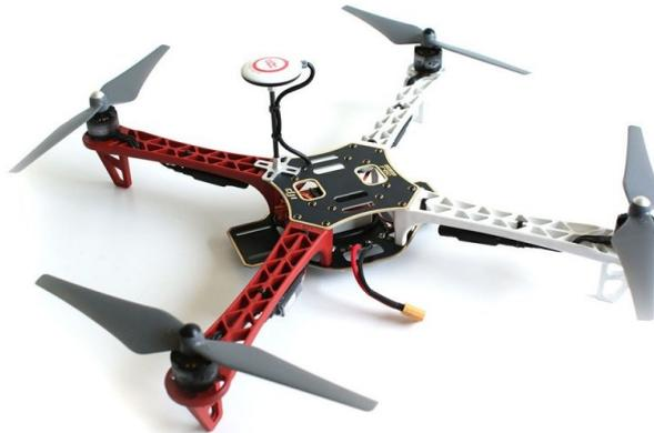
FIG. 3.4: VANT utilizado nos testes de voo, com carga paga de até 1,2 kg.
