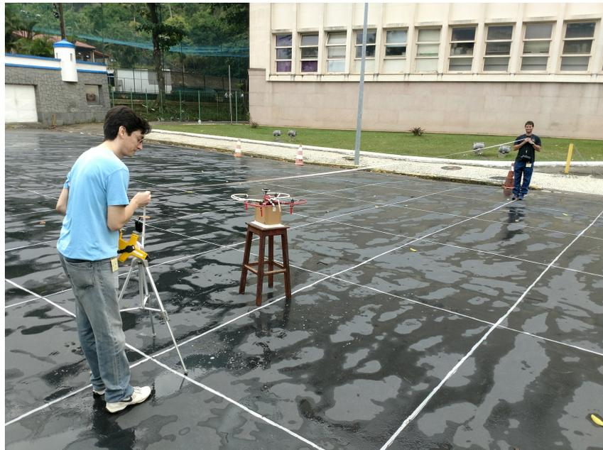
FIG. 4.7: Ensaio de coleta com o VANT em ambiente controlado e sem voo
