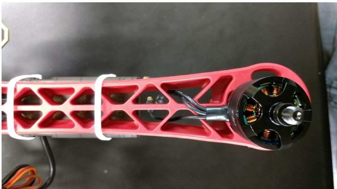
FIG. 8.13: Fixação do ESC com braçadeiras de nylon
