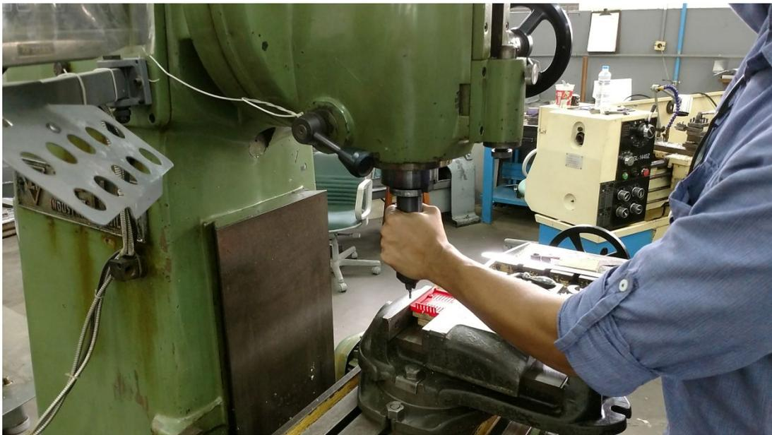
FIG. 8.16: Acabamento sendo aplicado em peças em plástico que contém imperfeições. Uma broca de precisão foi utilizada em algumas partes para nivelar os furos para o encaixe da placa Raspberry Pi
