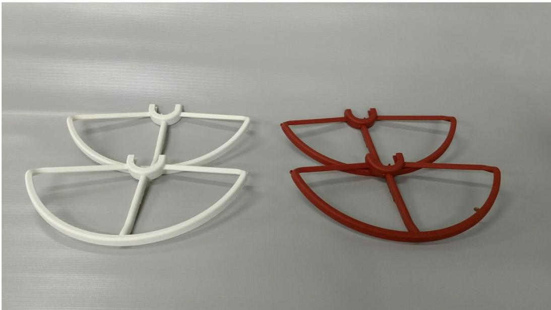
FIG. 8.4: Protetores de Hélices para o *frame* DJI F450
