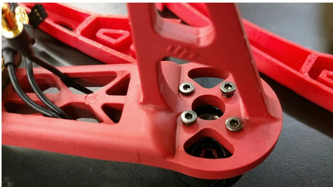
FIG. 8.14: Fixação dos rotores por parafusos e passagem dos cabos dos rotores pela estrutura do *frame*
