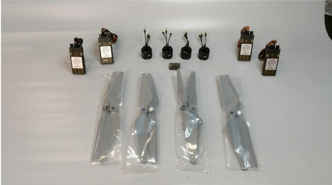
FIG. 8.3: Kit de propulsores, hélice e ESCs DJI modelo 4205
