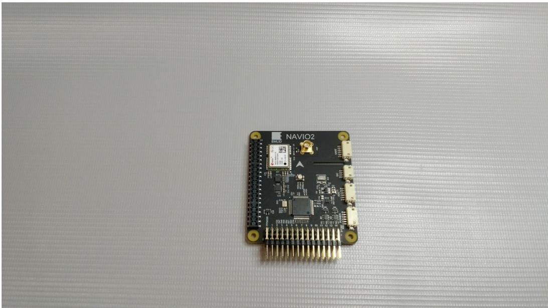
FIG. 8.6: Placa de piloto automático NAVIO2 da Emlid
